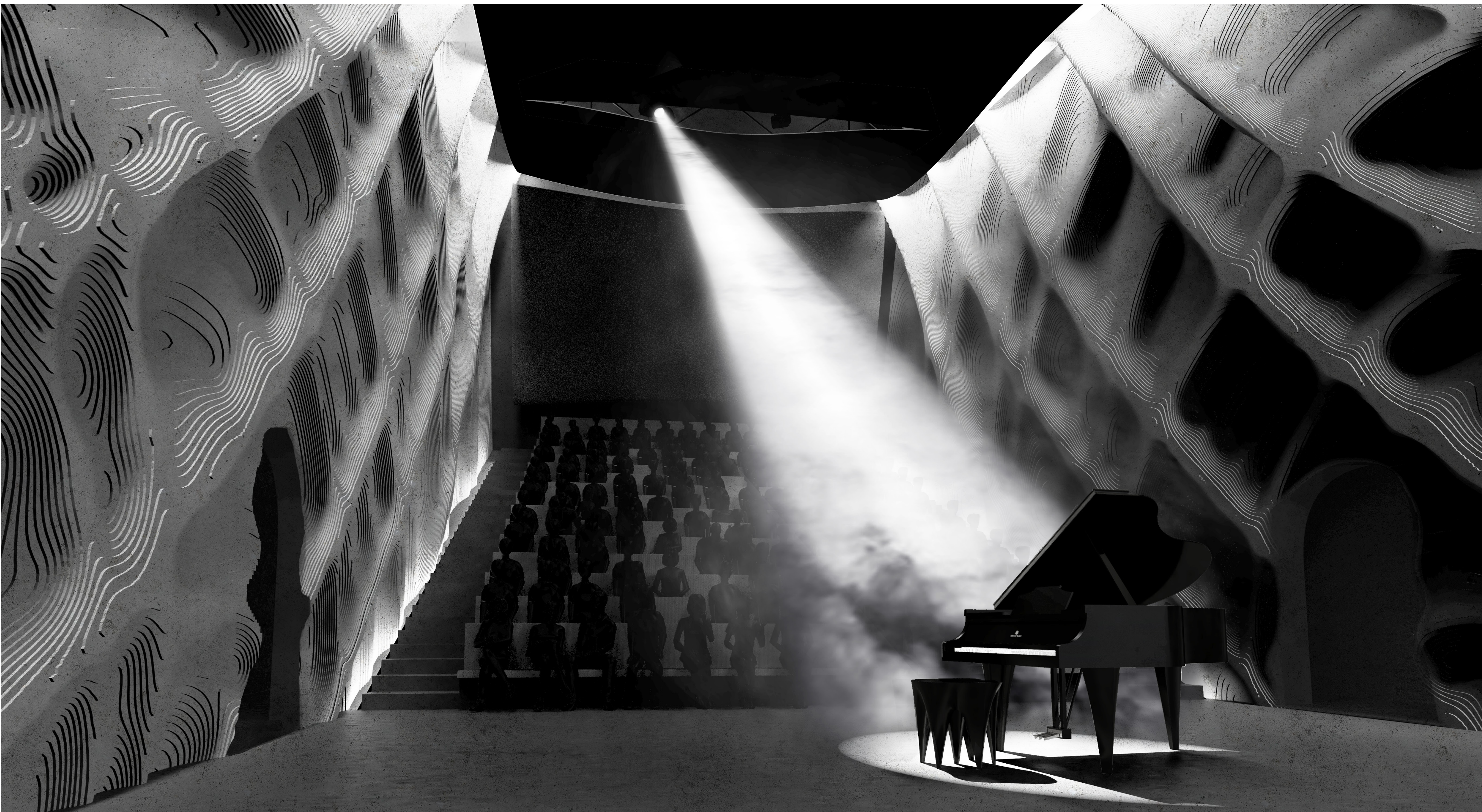
TOTALEMENT EN BÉTON COFFRÉ SUR PLACE À PARTIR DE CRE FRAISÉES NUMÉRIQUEMENT PAR CNC STRATÉ, PAR STRATE EXPOSANT LE FIN DISTRICIT DE TOUTE
